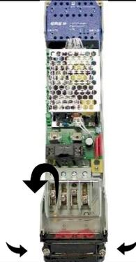
Schraube des Netzteils lösen und Netzteil vorklappen
